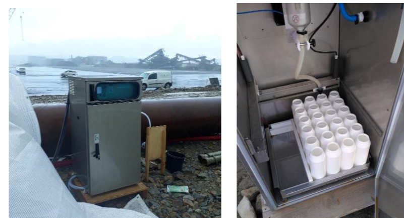
Figure 32 : Exemple de préleveur automatique 7 j – Source SDI/IDRA - PDPB
